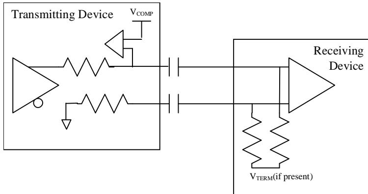
**Figure 18. AC Detect Circuit**
