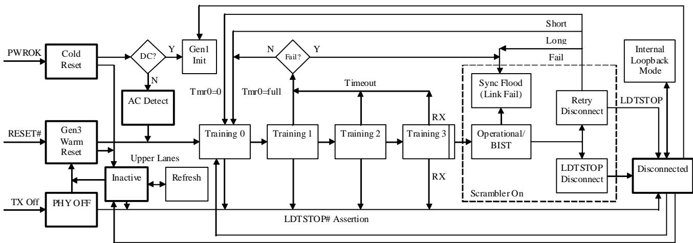
**Figure 17. Link State Diagram**
