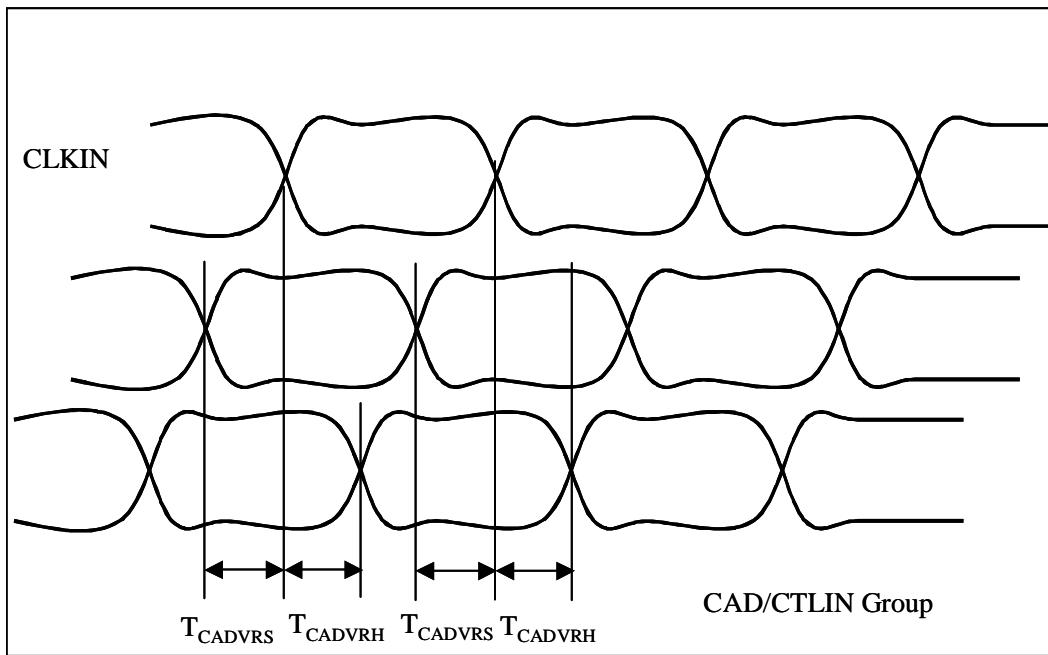
**Figure 47.  $T_{CADVRS}$  /  $T_{CADVRH}$**
